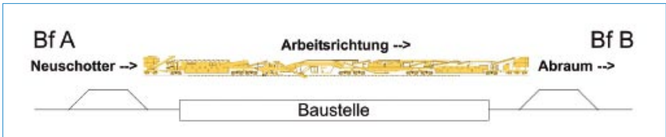
Bild 1: Baustelle für Schotterbettreinigung auf eingleisigem Streckenabschnitt
