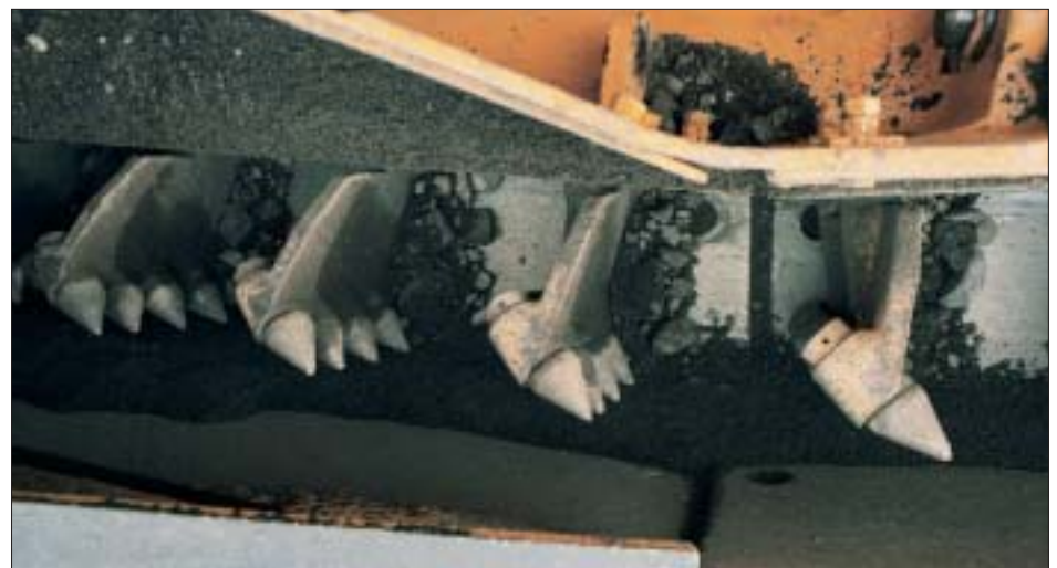
Bild 4: Aushubkette – Kratzerschaufel mit 4 Fingern
