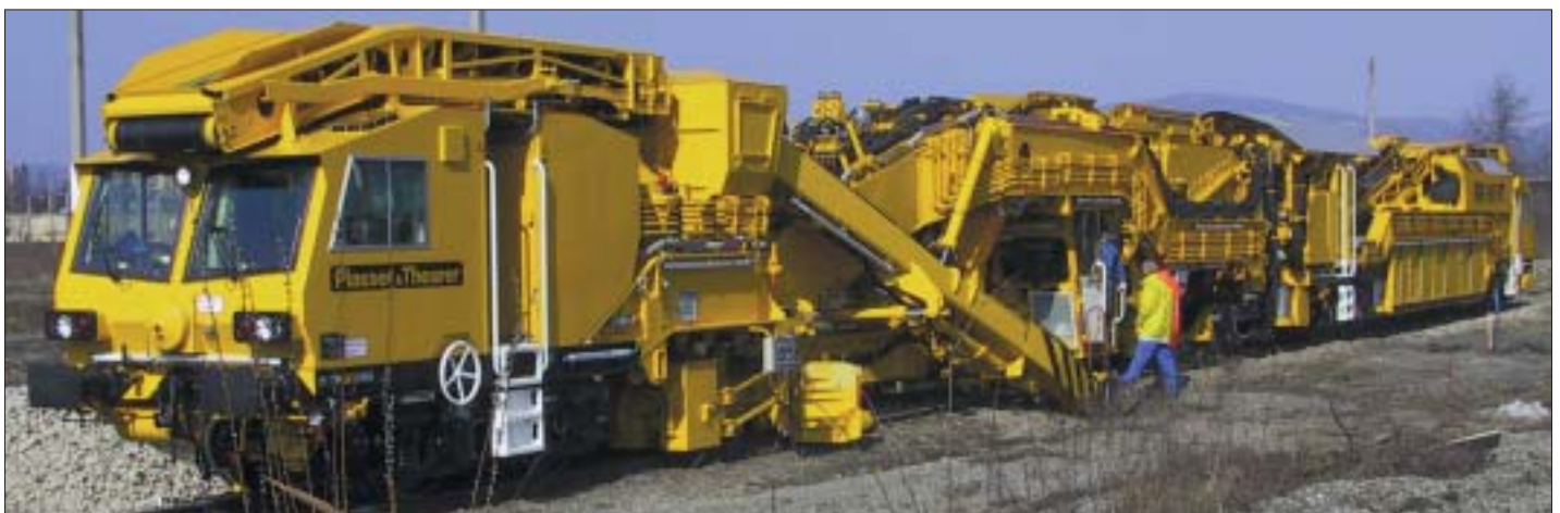
Bild 12: Bettungsreinigungsmaschine RM 95 RT in einem für die Britischen Eisenbahnen entwickelten Standard
