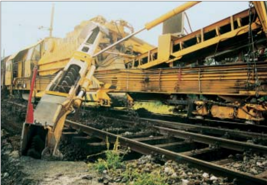
Bild 9: Erweiterung des Kettenquerbalkens zum Vergrößern der Räumbreite (Weichendurcharbeitung)
